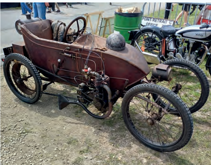
1914 Bramble franskprodusert oneoff, køyrt av entusiastisk ung brite. Motoren er montert langs sida.
