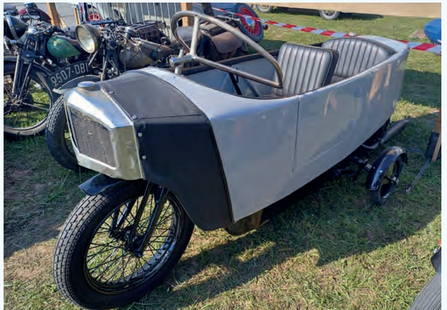
Visstnok ein 1924 Monotrace, to-hjuls tandem med støttehjul som ein kunne lyfte opp frå ca 10 km/t. Fantastisk å sjå desse køyre rundt i sakte fart gjennom depotet.
