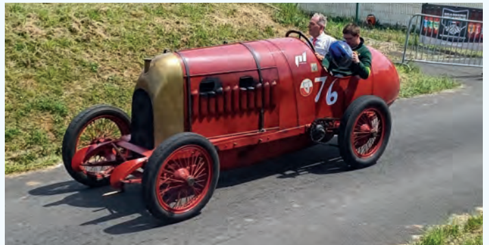
Kanskje den mest kjente av alle rekordbilane med flymotor. Denne, Fiat 576 frå 1910 går under kallenamnet «Beistet frå Torino» og har fire-sylindra motor på 28 liter. Fantastisk lyd og ein svært entusiastisk eigar som kørte på eigne hjul frå UK. Duncan Pittaway bygde opp bilen til 2015 basert på ein motor som kan ha stått i ein slik bil, pluss diverse delar blant anna funne i Sverige.
