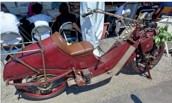
Mest spennande to-hjulning var denne tyske Megola med stjerne-motor roterande i framhjulsnavet.
