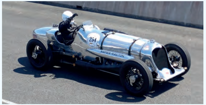
Nesten like imponerende som Renault var britiske Napier Railton sett saman av ein 12-sylindra flymotor og eit stort chassis. Har enno runderekorden på Brooklands og var eit mektig skue, ikkje minst når nokre sjåførar drog litt på.
